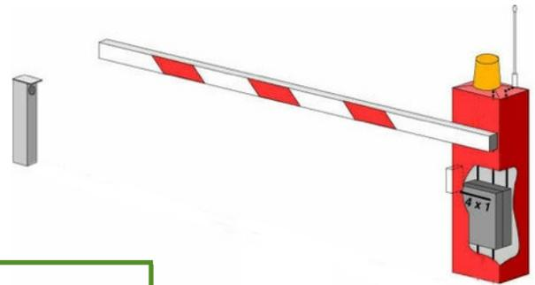
Une barrière de sécurité utilise un boîtier codé. Lorsqu'une voiture arrive, le conducteur doit saisir le bon code.
