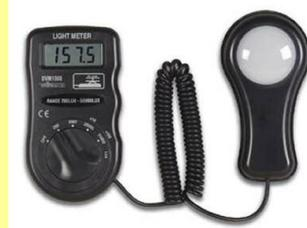
L'éclairage peut être mesuré à l'aide d'**un luxmètre**.
